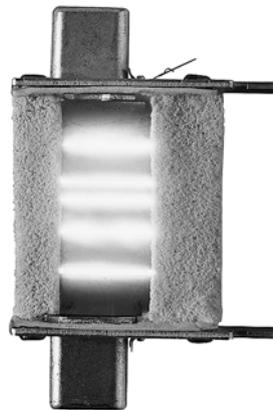
Быстрое возникновение электрической дуги и ее эффективное гашение являются предпосылками надежной отключающей способности.
