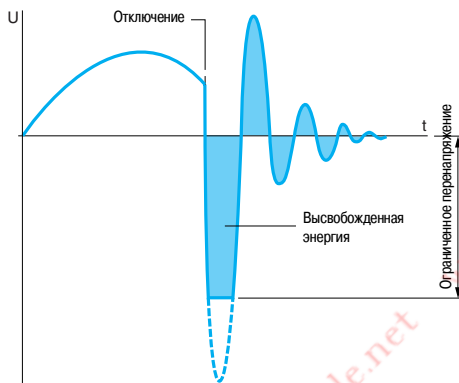
Напряжение катушки с варисторным модулем защиты (пер. и пост. ток)
