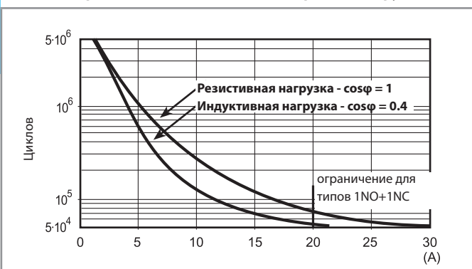
F 65 - Электрическая долговечность (AC) при ном. нагрузке
