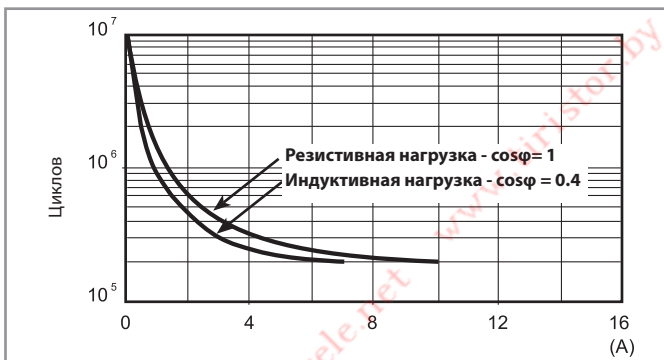
F 60 -Электрическая долговечность (AC) при ном. нагрузке
