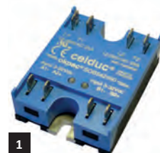
Двухфазное ТТР SOB для контроля нагревательных элементов, соединенных треугольником (для сбалансированных или несбалансированных нагрузок высокого напряжения)
